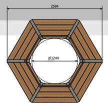
Sechseckige Bank, 6x60 Grad, Modell FalcoBloc mit Rückenlehne, Bankstützen Profil 80 mm, Sitz aus 3 Hartholzelementen 145x60 mm, Sitztiefe 42 cm, für frei stehende Anordnung mit Kappen, teilweise vormontiert, Stahlkonstruktion pulverbeschichtet in RAL \_\_\_\_, Farbe \_\_\_\_
