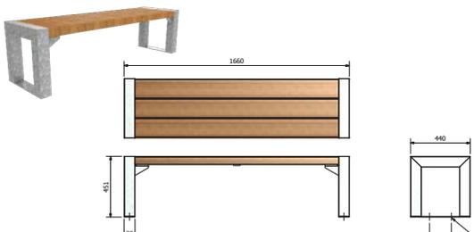
Bank Modell FalcoBloc mit Bankstützen Profil 80 mm, mit Streifen für Montage auf Beton Sitz aus 3 Hartholzelementen 145x60 mm, Sitztiefe 42 cm, Banklänge 166 cm, Stahlkonstruktion pulverbeschichtet in RAL \_\_\_\_\_, Farbe \_\_\_\_\_
