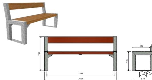
Bank Modell FalcoBloc mit Rückenlehne, Bankstützen Profil 80 mm, mit Streifen für Montage auf Beton, Sitz aus 3 Hartholzelementen 145x60 mm, Sitztiefe 42 cm, Banklänge 166 cm, Stahlkonstruktion pulverbeschichtet in RAL \_\_\_\_\_, Farbe \_\_\_\_\_
