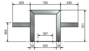
Picknicktisch Modell FalcoBloc, Stützen Profil 100 mm, jeder Sitz aus 2 Hartholzelementen 145x60 mm, Tisch aus 5 Hartholzelementen, Abmessung 170x72,5 cm, mit Streifen für Montage auf Beton,
