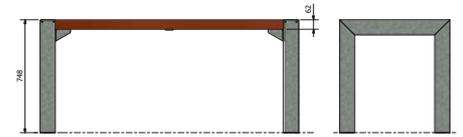
Tisch Modell FalcoBloc mit Tischbeinen Profil 80 mm, Tisch aus 5 Hartholzelementen 145x60 mm, Länge 170 cm, Breite 70 cm, Höhe 75 cm, für frei stehende Anordnung mit Kappen,
