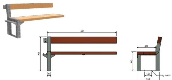
Anbaubank Modell FalcoBloc mit Rückenlehne, 1 Bankstütze Profil 80 mm mit Befestigungsleiste zur Montage auf Beton, Sitzfläche aus 3 FSC®-zertifizierten Hartholzteilen 145x60 mm und Sitztiefe 44 cm, Banklänge 166 cm, teilweise vormontiert ,
