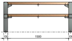
Picknicktisch Modell FalcoBloc, Stützen Profil 100 mm, jeder Sitz aus 2 Hartholzelementen 145x60 mm, Tisch aus 5 Hartholzelementen, Abmessung 170x72,5 cm, Montage über die Bankbeine, ausgeführt ohne Tischbeine
