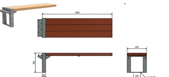
Anbaubank Modell FalcoBloc mit 1 Bankstütze Profil 80 mm, mit Befestigungsleiste zur Montage auf Beton, Sitzfläche aus 3 FSC®-zertifizierten Hartholzteilen 145x60 mm und Sitztiefe 44 cm, Banklänge 166 cm, teilweise vormontiert,
