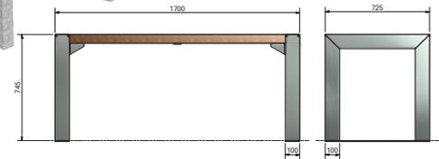
Tisch Modell FalcoBloc mit Tischbeinen Profil 80 mm, mit Streifen für Montage auf Beton, Tisch aus 5 Hartholzelementen 145x60 mm, Länge 170 cm, Breite 70 cm, Höhe 75 cm,
