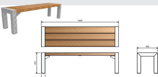
Bank Modell FalcoBloc mit Bankstützen Profil 80 mm, Sitz aus 3 Hartholzelementen 145x60 mm, Sitztiefe 42 cm, Banklänge 166 cm, für frei stehende Anordnung mit Kappen, Stahlkonstruktion pulverbeschichtet in RAL \_\_\_\_\_, Farbe \_\_\_\_\_
