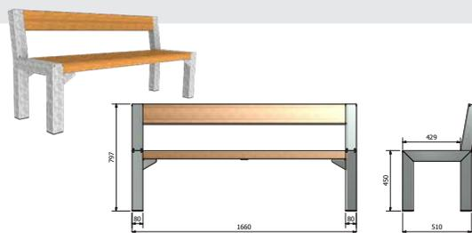
Bank Modell FalcoBloc mit Rückenlehne, Bankstützen Profil 80 mm, Sitz aus 3 Hartholzelementen 145x60 mm, Sitztiefe 42 cm, Banklänge 166 cm, für frei stehende Anordnung mit Kappen,
